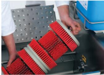
≡ Reinigungsmittel und Wasser werden über separate Rohre einzeln zugeführt und auf den Bürsten vermischt. Nach der Reinigung erfolgt ein Spülgang mit klarem Wasser. Durch die Rohrtrennung werden die Vorschriften des DVGW erfüllt.
