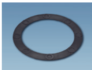
Art.Nr. 125/2 Drainagering Ringspalt zwischen Bodenablauf-Unterteil und Rinnenstutzen bleibt zur sekundären Entwässerung offen (bauseits abklären).
